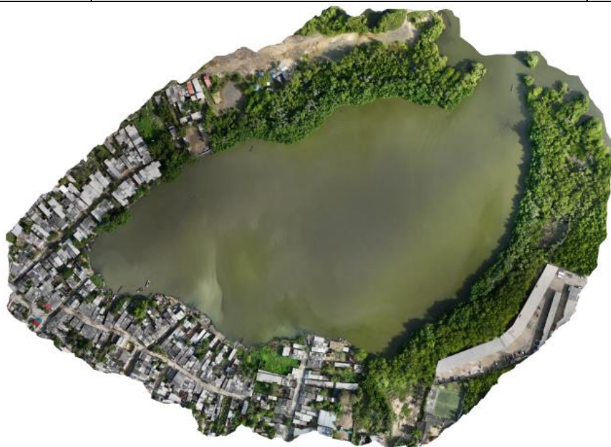
Figura 1. Mapa RGB en Ultra-Alta Resolución (GSD de 3.65 cm/píxel) de la ensenada de Puerto Mosquito (ubicada en Ciénaga de Mallorquín). Producto Geomático obtenido durante el ejercicio de validación del método Ecodron. Elaboración Propia.
